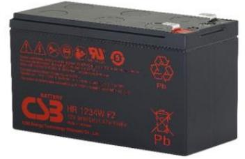
HR 1234W - батарея с высокой энергоемкостью. Особенная кристаллическая решетка электродов позволила увеличить на 20% отдаваемую мощность по сравнению с батареями других серий. Она разработана для эксплуатации в режиме высоких токов разряда при коротком времени разряда. Срок службы более 5 лет в буферном режиме или более 260 циклов заряда-разряда в циклическом режиме при 100% разряде.
